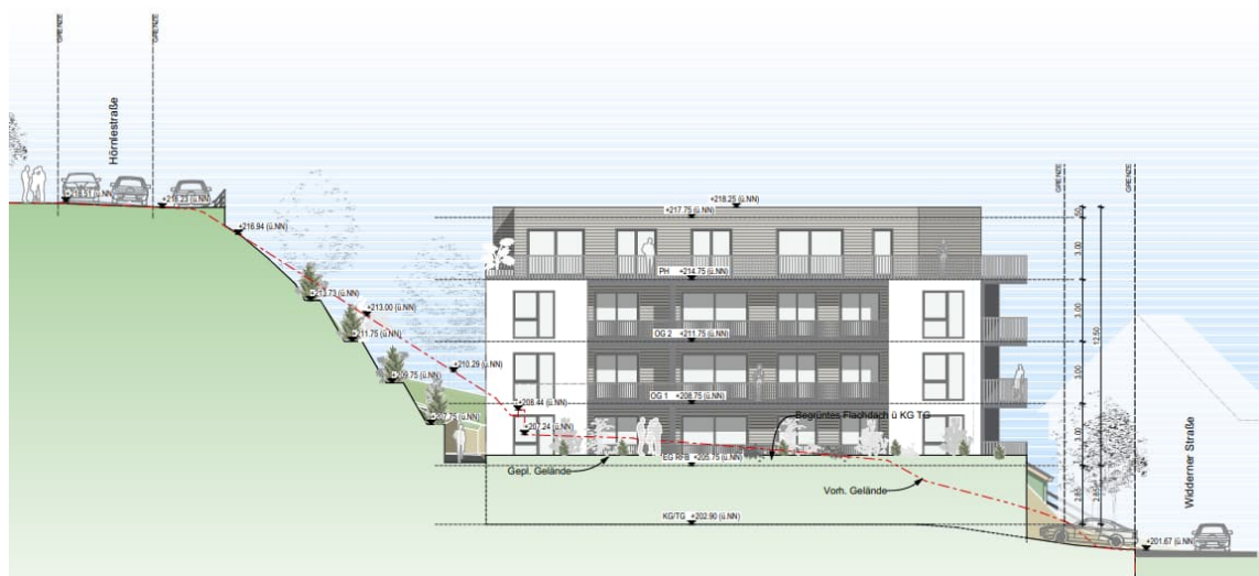
Abb. 8: Geländeschnitt, Ansicht von Westen (Quelle: Ingenieurbüro Krasniqi)
